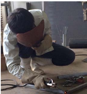
ガス・アーク溶接
