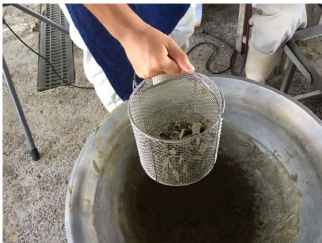
ヘラで細断後、編み目状のカゴに入れてふるいにかけて、固体と粉に分けて完了。
