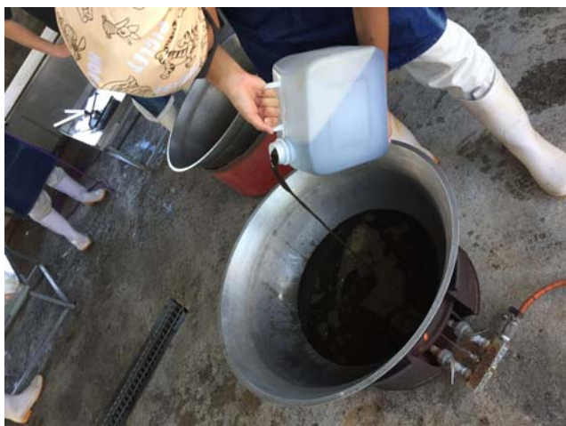
サトウキビを搾って濃縮した原液をシンメーナベに投入。ガス釜かけ更に濃縮します。
