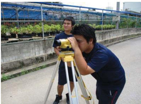
水準測量 機械で標尺を視準します（高低差を測ります）
