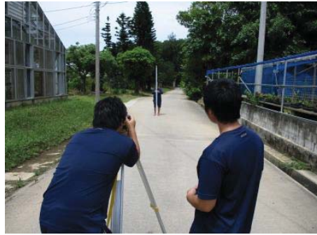
水準測量 機械で標尺を視準します（高低差を測ります）
