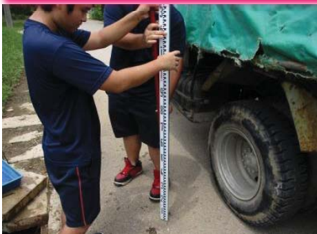
排水溝の蓋を取り外し、体積土壌を調査&計測
