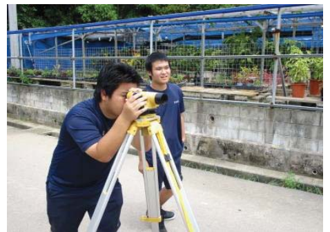
水準測量 機械で標尺を視準します（高低差を測ります）
