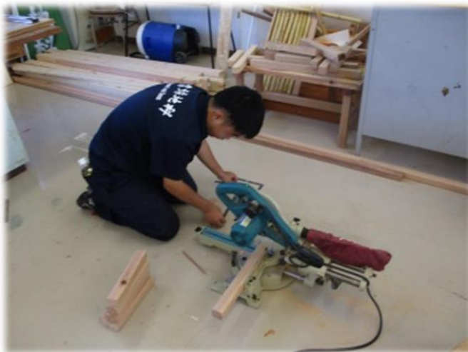
スライド丸鋸で切断します
